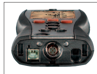
Разъемы на управляющем модуле
