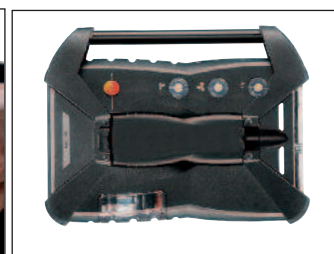
Для безопасности при транспортировке управляющий модуль устанавливается в блок анализатора обратной стороной
