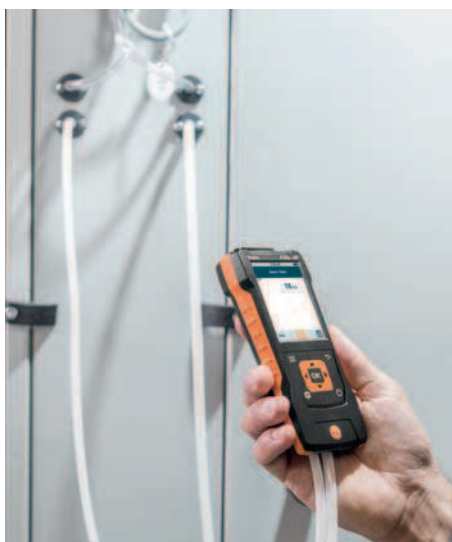
Модель testo 440 dP, включающая сенсор дифференциального давления, позволит вам своевременно принять решение о замене фильтров систем кондиционирования, так, чтобы никакое загрязнение снаружи не попало в воздух помещения
