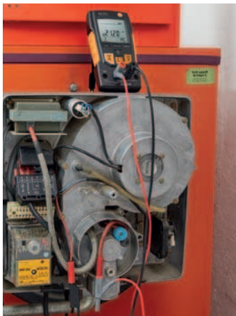
Измерение потока ионизации с testo 760
