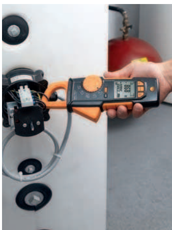
Измерение напряжения на бойлере с testo 770
