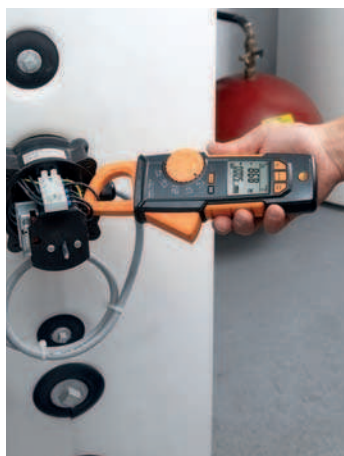
Измерение напряжения на бойлере с testo 770
